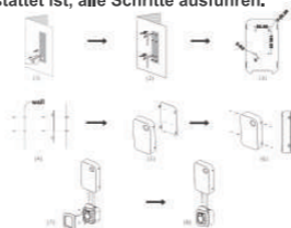
Abb. 2 Installationszeichnung für wandmontiertes Ladegerät
